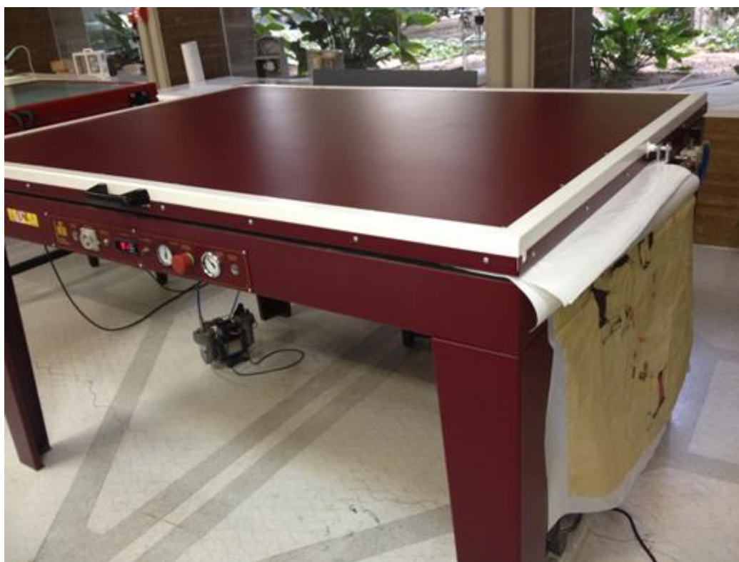
Ilustración 4. Laminación mecánica de los calcos utilizada en los casos de papel friable y degradación acusada. Fotografía: Trama, S.C.
